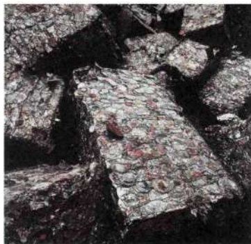
Алюминиевые отходы, спрессованные в блоки, — сырьё для металлургического производства.
