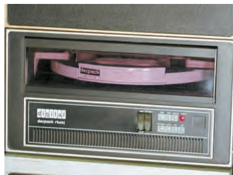
Дисковод сменного магнитного диска PDP-11 объёмом 2,5 Мбайт.
